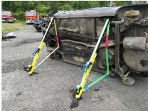
La connaissance de la mise en œuvre des différents procédés pour caler et stabiliser un véhicule est primordiale durant des opérations de secours routier que ce soit en intervention ou en manœuvre.
