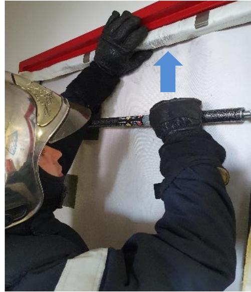
4. Serrez jusqu'à être en pression sur les montants de la porte
