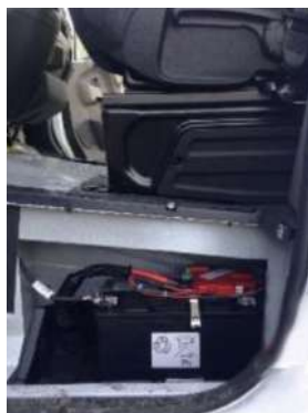
Exemple Renault Master ZE (sous siège conducteur)
