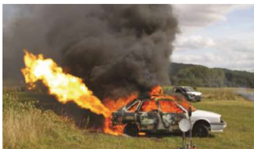
VL sur ses roues Torchère en phase gazeuse, cycles réguliers
