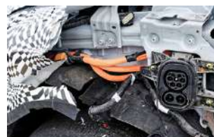
Prise de charge et câble HT dans l'aile
