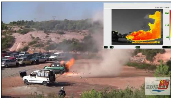
Figure 6 : Feu de VL hydrogène, réservoir à 700b (réalisé par le SDIS 44)
