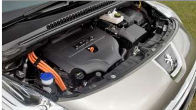
Figure 3 : Mise en évidence des câbles HT
