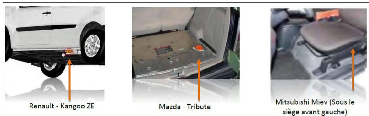
Figure 6 : exemple de position du système plug
