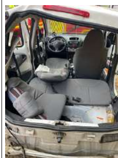
Cross-Raming, démontage et écrasement de banquette, abaissement de siège
