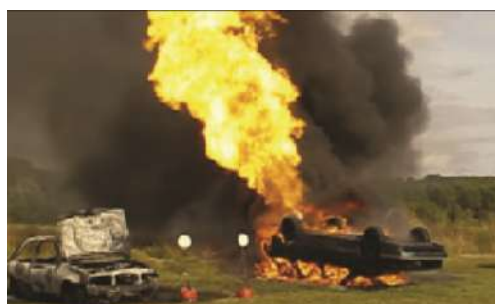
VL sur le toit Torchère en phase liquide, en continue
