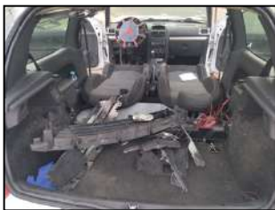
Démontage banquette et abaissement sièges
