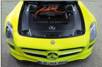
Figure 4 : câbles orange HT
