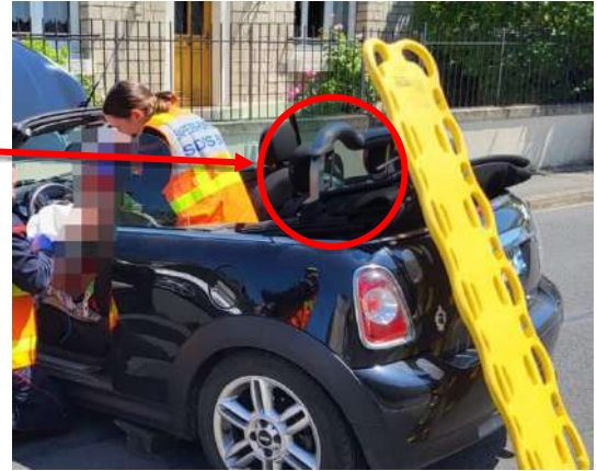
Arceau pyrotechnique état initial et déclenché
