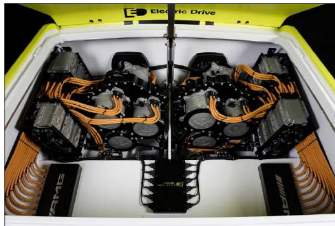
Figure 4 : Mise en évidence des câbles HT
