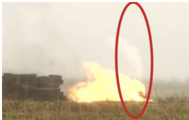
Figure 5 : Essai de brûlage véhicule GNL (torchère en haut)
