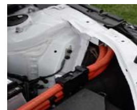
Prise de charge et câble HT dans l'aile
