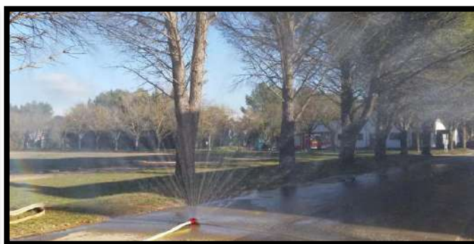
Etablissement d'une lance canon et d'une lance queue de paon
