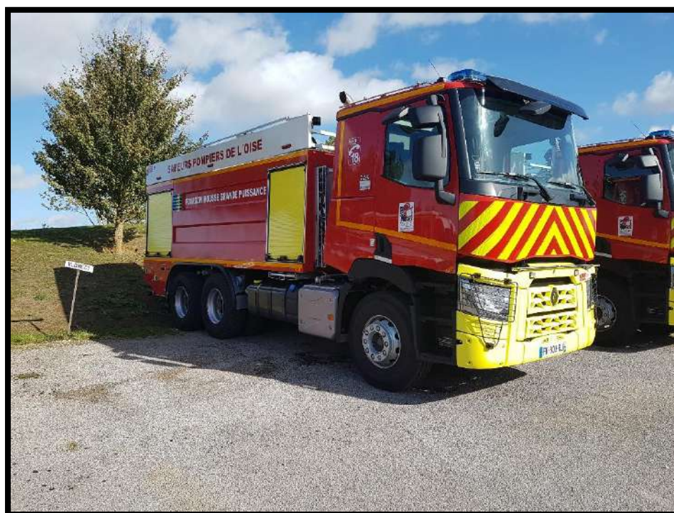
F.M.O.G.P Creil et Compiègne 8000 L d'eau 3000 L d'émulseur et 120 L d'additif
