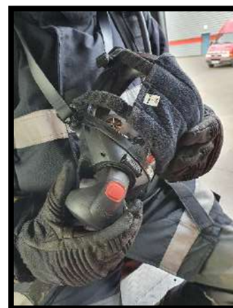
Connecter la S.A.D sur le masque (bruit de clic fort) Vérifier la bonne fixation
