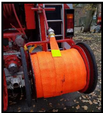
Tuyaux de 70 en dévidoir
