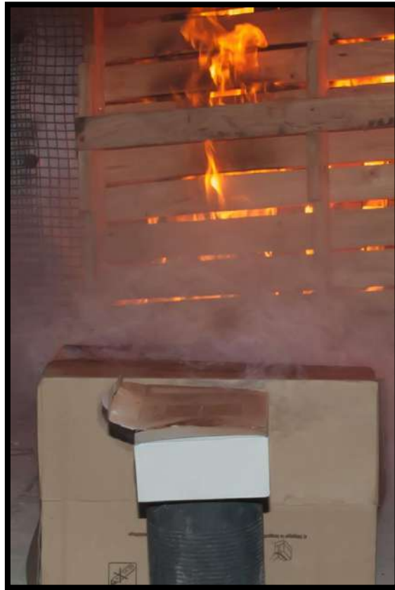
Pyrolyse d'une Boîte en carton soumise à la chaleur d'un incendie
