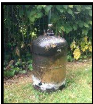
Bouteille de gaz chauffée lors d'un incendie
