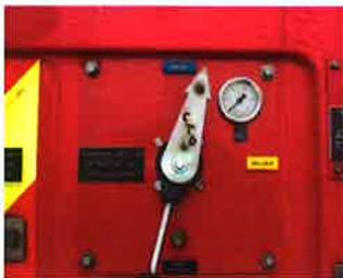
Positionner la vanne 4 voies « rinçage »
