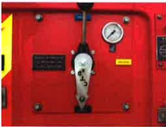
Positionner la vanne 4 voies « arrêt dosage »
