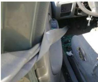
Nouer l'autre extrémité au montant de la portière entre-ouverte (vitre baissée ou retirée).
