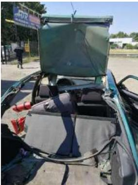
La réalisation du tunnel permet une extraction de victime par l'arrière du véhicule sans avoir à sectionner les montants du véhicule.
