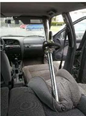
Choisir un vérin adapté à la distance entre le dossier du siège et le pavillon au niveau des montants A.
