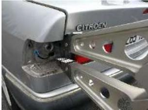
L'ouverture du coffre ou du hayon nous permet d'extraire une victime ou de réaliser d'autres techniques de désincarcération
