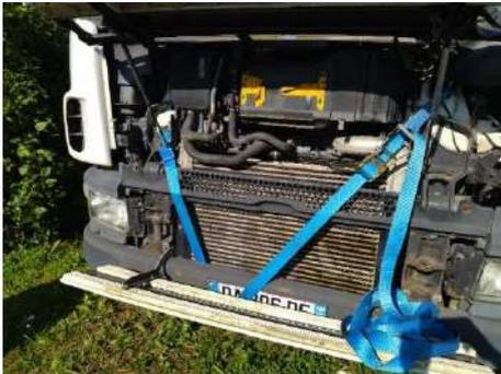
Veuillez préalablement à mettre en place des cales entre la cabine et le châssis ou les roues avant de brider la cabine avec la sangle d'arrimage.
