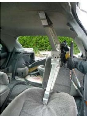
Manœuvrer l'écarteur pour abaisser le siège vers l'arrière du véhicule.
