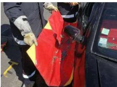
Il est possible de faire un réceptacle au moyen d'une protection de coupe mise en place sur le véhicule en forme de cuvette. Celle-ci est maintenue au moyen des parties aimantées et par un équipier.
