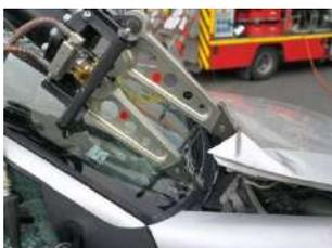
L'ouverture du capot situé à l'avant du véhicule va nous permettre d'accéder à la batterie si elle est située dans cette partie ou afin de réaliser des techniques de désincarcération
