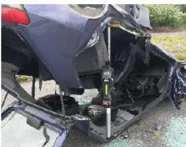
Couper les montants Centraux et arrière et fragiliser si nécessaire les montants A par la réalisation de coupes de décharge au niveau du pavillon.
