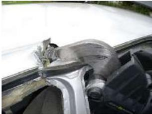
Après avoir réalisé une ouverture de porte Avant et Arrière, il sera nécessaire de retirer le montant B afin de créer une baie latérale.
