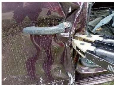
Insérer l'écarteur au niveau de la serrure et procéder à l'ouverture de la portière en le rapprochant au fur et à mesure de la serrure.
