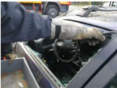
Il est possible de retirer le joint de vitre afin de retirer les morceaux de verre présents. Dans ce cas, le placer dans la caisse avec les débris.
