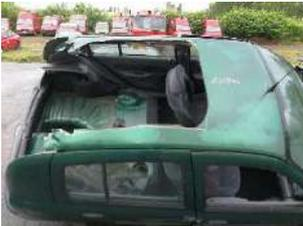
La scie sabre permet de créer des ouvertures là où les cisailles n'ont pas accès et également de couper des montants et des renforts.
