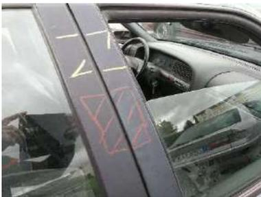
Localisation d'une zone renforcée interdite à la découpe (fixation de la ceinture de sécurité).
