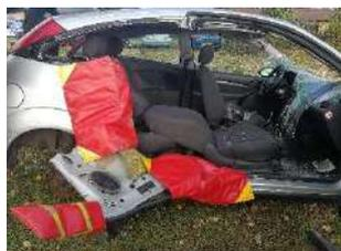
Les véhicules 3 portes réduisent la capacité de sortie d'une victime.
