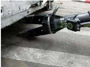
L'utilisation d'un écarteur pour lever un véhicule est gage de rapidité, soit pour dégager une victime nécessitant une extraction immédiate, soit par l'absence de coussin de levage.
