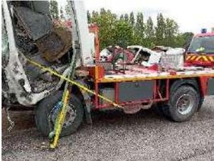
Les véhicules types PL possèdent souvent une suspension pneumatique de cabine. La hauteur sous le véhicule rend également particulier le calage et la stabilisation de ce type de véhicule.
