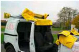
Basculer un demi-pavillon par l'avant, par l'arrière ou latéral permet un accès à une ou plusieurs victimes en gagnant du temps.
