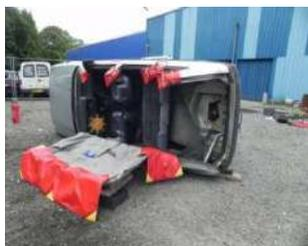
La manœuvre consiste à réaliser un accès à une victime incarcerated dans un véhicule sur le côté et afin de l'extraire de celui-ci.
