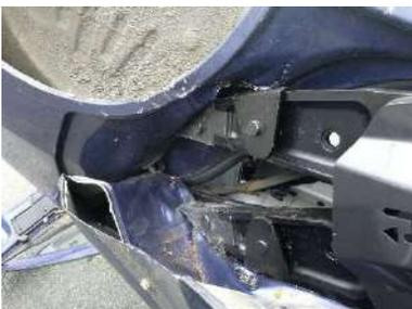
Déplacer si nécessaire l'écarteur pour le rapprocher de la serrure et procéder à l'ouverture de la portière.
