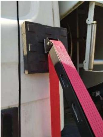
Il est possible d'augmenter la surface de contact sur la charge afin d'offrir une plus grande résistance en intercalant une cale entre l'appui et la charge.
