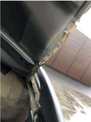
La réalisation préalable de deux coupes de décharge au niveau du pavillon, va permettre de « déboutonner » celui-ci par rupture des points de soudure lorsque le vérin va le pousser.
