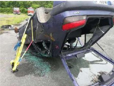
Stabilisation d'un véhicule sur le toit avec préservation de l'axe de sortie arrière.
