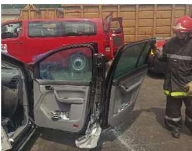
Couper si nécessaire l'arrêt de porte pour une plus grande ouverture et maintenir le tout avec une Rope-Ratchet ou une commande.
