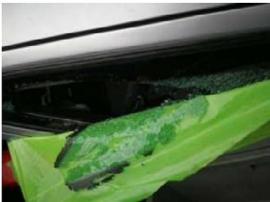
La vitre préalablement filmée évite la dispersion et projection des morceaux de verres en les fixant sur le film.
