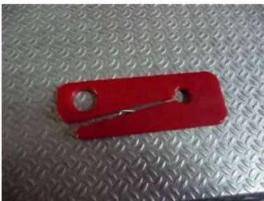
Le coupe ceinture permet de couper les ceintures de sécurité au plus près de l'enrouleur avant les opérations de désincarcération. Le tressage spécifique des ceintures les rendent très résistantes. Une section au coupe ceinture réalisée en biais est plus efficace qu'une découpe droite.
