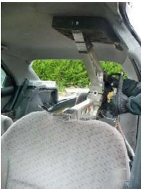
Placer la pointe inférieure de l'écarteur sur le siège.
