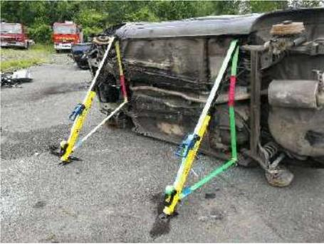
Stabilisation d'un véhicule sur le côté.
