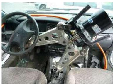
Placer l'écarteur entre la partie inférieure du volant et l'embase du levier de vitesse et actionner l'écarteur pour lever le volant (attention à ne pas le positionner sur l'ECU).
