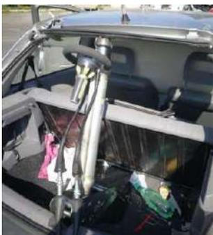
Intercaler une cale (sabot de vérin ou cale polyéthylène ou cale en bois) entre le plancher du coffre ou sur le dossier de la banquette arrière et le vérin (partie non télescopique du vérin sur la cale).
