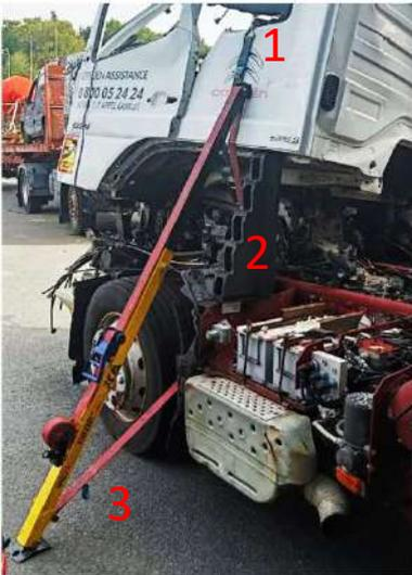
La sangle d'arrimage « 1 », maintient la cabine en appui sur les cales « 2 », qui sont positionnées sur le châssis évitant ainsi qu'elle ne bouge. L'étais à sangle « 3 », stabilise la cabine en neutralisant un point de pivot.
