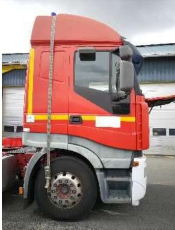
L'utilisation des sangles d'arrimage permettent de neutraliser la suspension pneumatique de la cabine que ce soit sur l'avant ou l'arrière de celle-ci.
