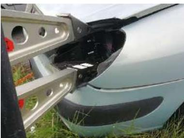
Si en tirant le câble ça ne fonctionne pas, placer l'écarteur dans l'emplacement de l'optique ou au niveau de la calandre et ouvrir le capot en manœuvrant l'écarteur. Se rapprocher si besoin de la serrure.
