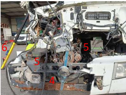
La sangle d'arrimage « 4 », maintient la cabine en appui sur les cales « 5 », qui sont positionnées sur le châssis évitant ainsi qu'elle ne bouge. Les étais à sangle « 6 », stabilise la cabine en neutralisant deux points de pivot.
