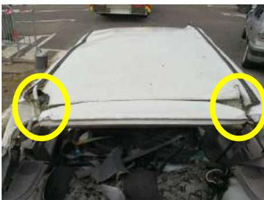
Sectionner le pavillon dans le sens longitudinal à proximité des montants arrière au niveau du rail de toit (jonction pavillon / montant).
