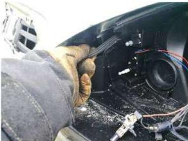
Saisir le câble de commande d'ouverture du capot moteur et tirer dessus (action identique qu'avec la commande située dans l'habitacle).
