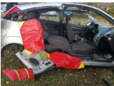
Le siège avant peut être basculé vers l'arrière pour permettre une sortie oblique d'un passager avant ou vers l'avant pour permettre une sortie d'un passager arrière.
