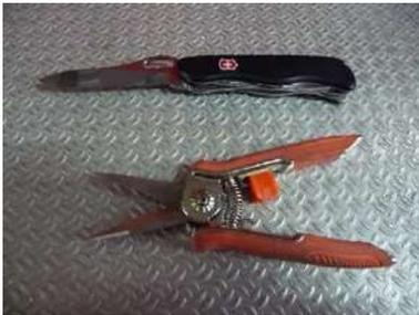
Le couteau et le sécateur vont permettre de couper les câbles électriques une fois la ou les batteries neutralisées (uniquement de la basse tension), les joints de portière, les tuyaux de fluides non dangereux (lave glace) si possible avant les opérations de désincarcération.
