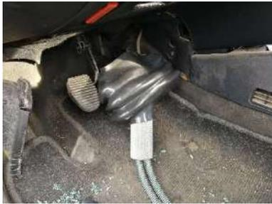
Sectionner la ou les pédales au moyen du coupe pédale s'il est possible de l'insérer.
