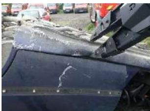
Un véhicule placé sur le toit peut rendre les opérations d'ouverture de porte difficile. Si l'ouverture de porte par la serrure ne fonctionne pas, il faudra utiliser cette technique.
