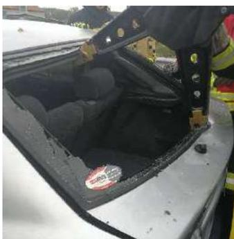
**Avant toute action de désincarcération, vérifier que le coffre/hayon ne s'ouvre pas d'une façon normale ou depuis l'intérieur (safety release).**
