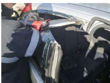
Placer l'écarteur dans le cadre de vitre et basculer la partie sectionnée vers l'extérieur.
