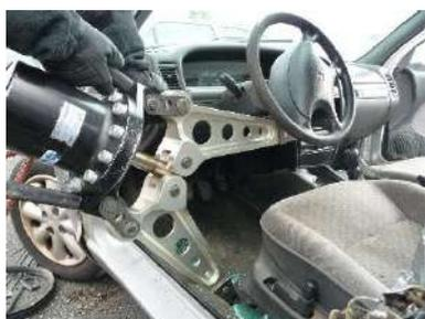
Placer l'écarteur entre la partie inférieure du volant et le bas de caisse puis actionner l'écarteur pour lever le volant.
