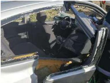
Placer ensuite le vérin adapté à la distance entre le montant B mobile et le rail de toit puis déployer le vérin pour continuer de déplacer le montant vers l'extérieur.
