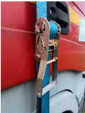
Actionner le cliquet pour mettre en tension la sangle en veillant à ce que les deux sangles ne se croisent pas.
