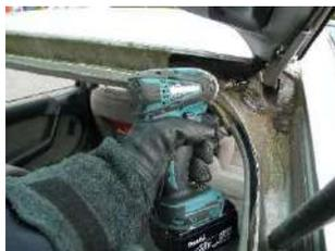
Le démontage de certains éléments d'un véhicule est intéressant afin de créer un accès pour extraire une victime.
