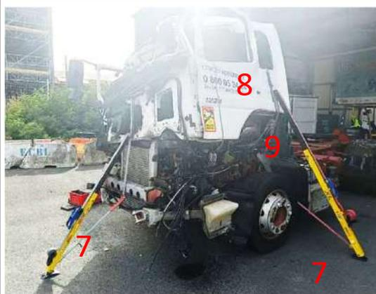
La sangle d'arrimage « 8 », maintient la cabine en appui sur les cales « 9 », qui sont positionnées sur le châssis évitant ainsi qu'elle ne bouge. Les étais à sangle « 7 », stabilise la cabine en neutralisant deux points de pivot.
