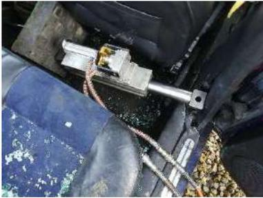
Un vérin peut être utilisé pour pousser le montant B. Le placer entre la cave à pied et le bas du montant B qui a été sectionné.
