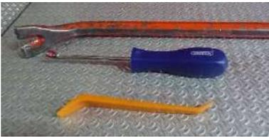
Ces outils vont permettre d'écarter et de retirer les clips des plastiques intérieur afin de visualiser les zones de renforts, fixations de ceintures de sécurité, prétentionneurs de ceintures de sécurité, cartouches pyrotechniques, sacs d'airbag...
