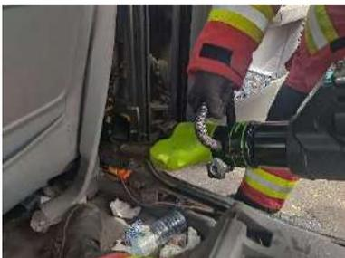
Si nécessaire, sectionner au moyen de la cisaille les éléments de tôle du montant B empêchant la manœuvre.
