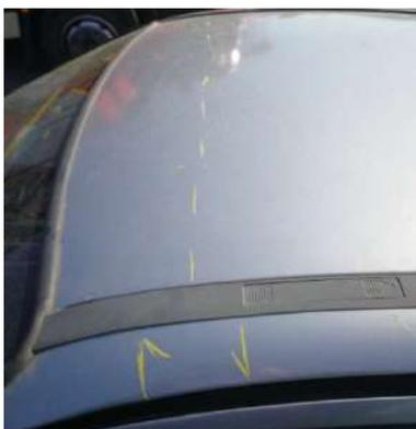
Procéder à la coupe du pavillon à la scie sabre. Il est alors inutile de retirer le pare-brise (cf : chap.4 utilisation de la scie sabre page 66)
