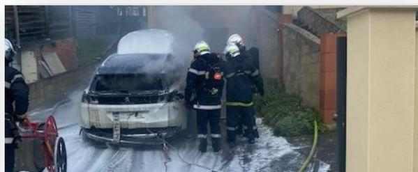
Emballement thermique d'une batterie Lithium-Ion sur une Peugeot 308 avec propagation au véhicule dans l'Oise en 2022.
