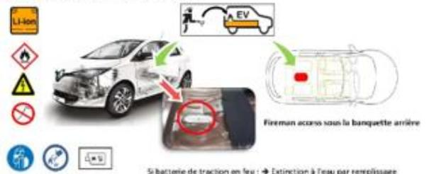
Si batterie de traction en feu : Extinction à l'eau par remplissage
