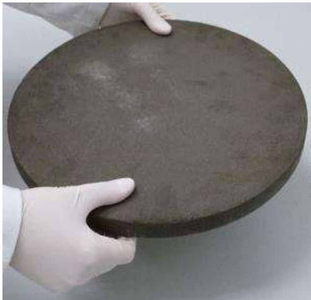
Composite à base d'hydrures de magnésium contenant 600 litres d'hydrogène © McPhy
