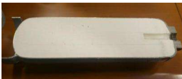
Coupe d'une bouteille d'acétylène © pnrs.ensosp.fr
